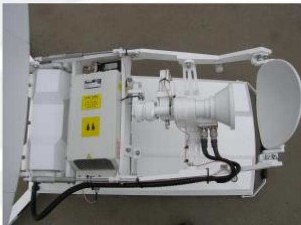
Il cablaggio RF e connessione di alimentazione tra i vari blocchi che compongono il sistema sono forniti di serie (3m).
